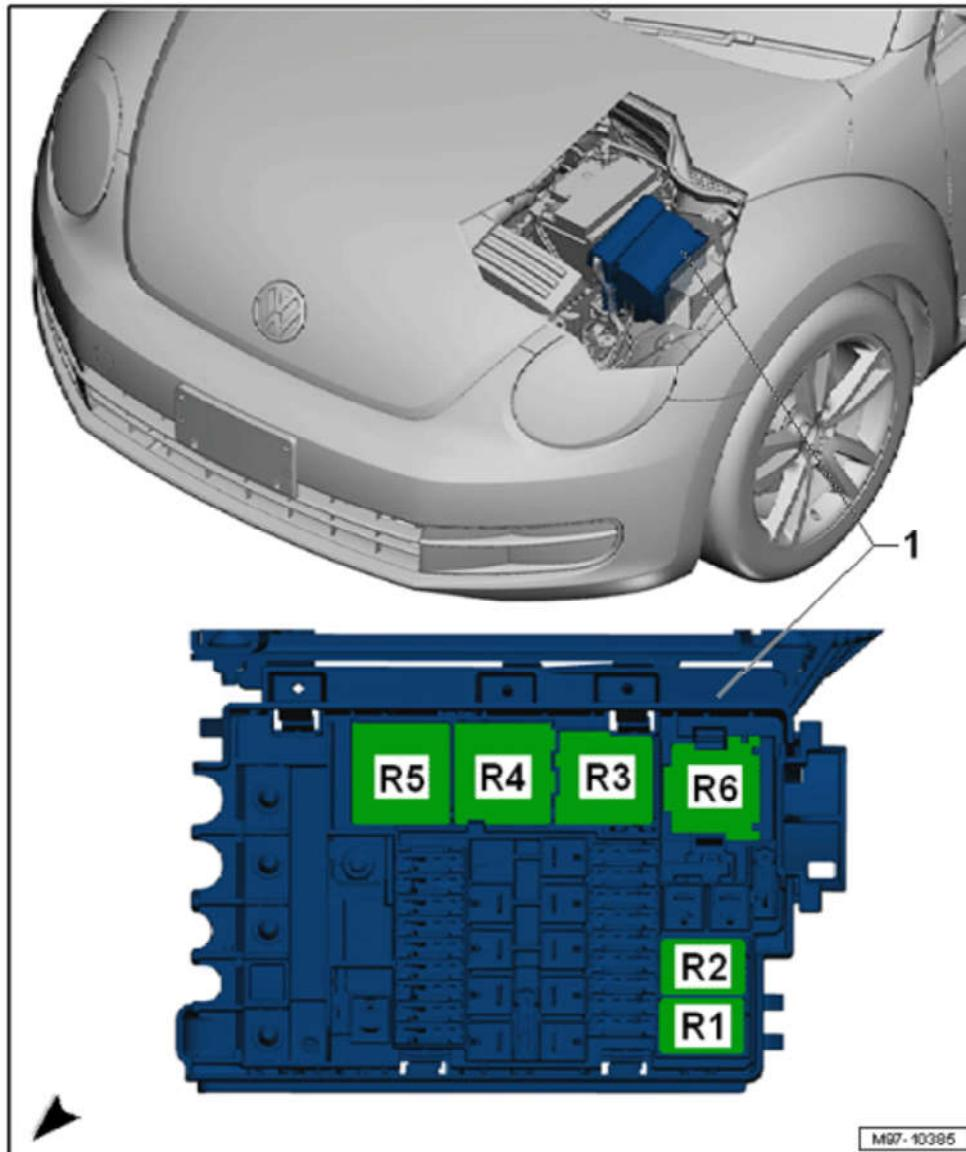
1 - 继电器和保险丝座 1 -SR1- , 在发动机舱内的电控箱上
